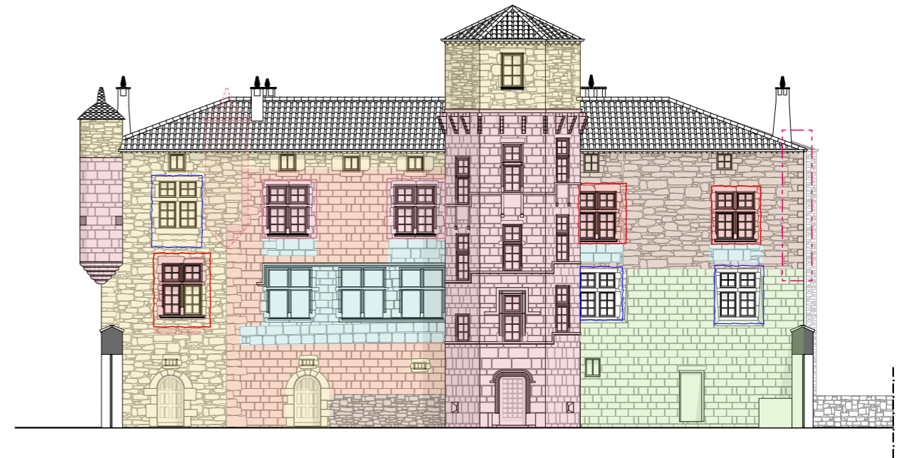
(4) État des fenêtres à croisée du 1 er niveau avant transformation
